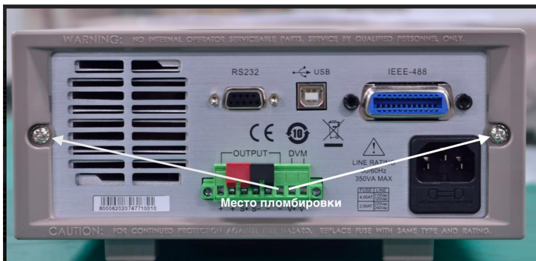
Рисунок 2 – Схема пломбировки от несанкционированного доступа
