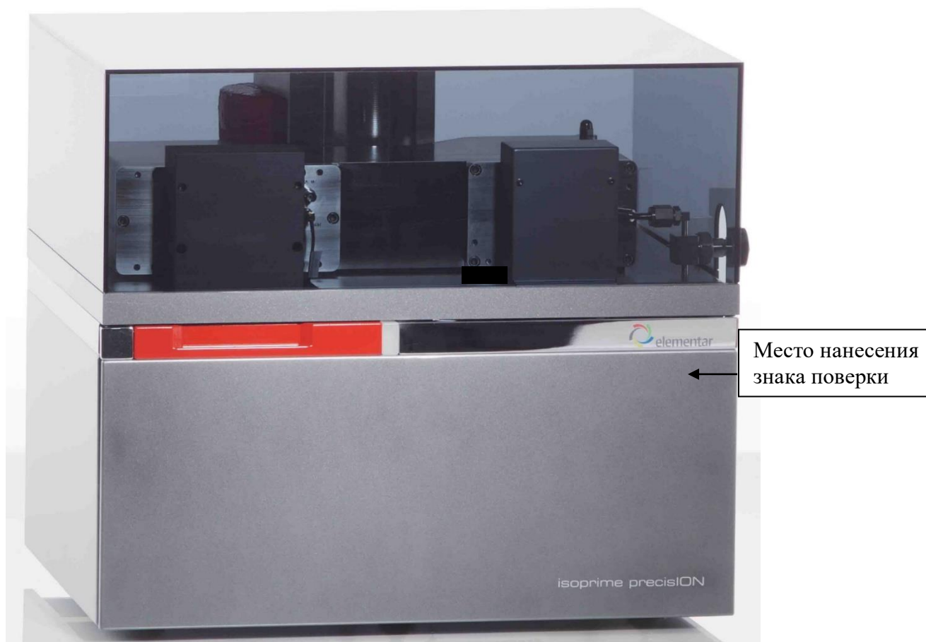
Рисунок 1 - Общий вид масс-спектрометра isoprime precisION с местом нанесения знака поверки
