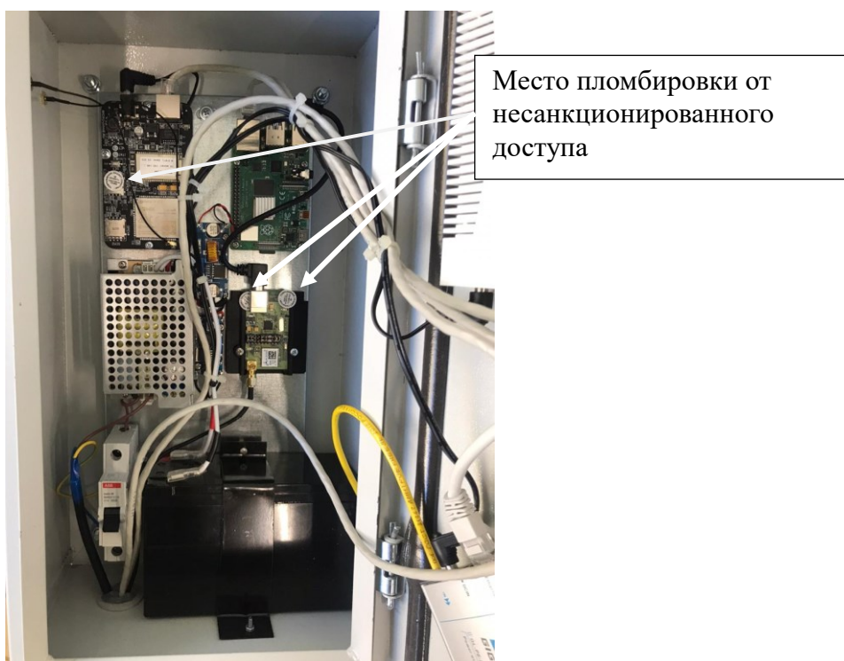
Рисунок 2 – Схема пломбировки комплексов от несанкционированного доступа
