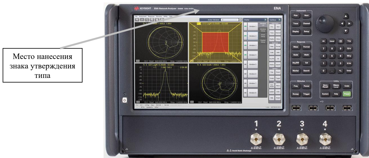
Рисунок 1 – Общий вид анализаторов E5080B, вид спереди
