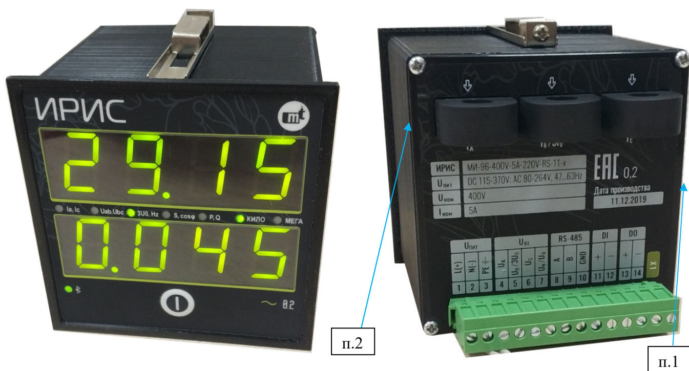
Рисунок 1 – Общий вид приборов с указанием места нанесения знака поверки и места пломбирования (п. 1 – место нанесения знака поверки; п. 2 – место пломбирования)
