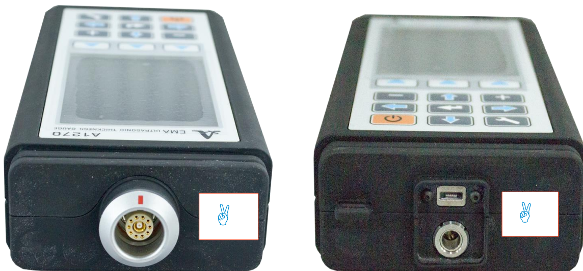
Рисунок 2 – Места пломбировки корпусов толщиномеров ультразвуковых электромагнитно-акустических серии A1270
