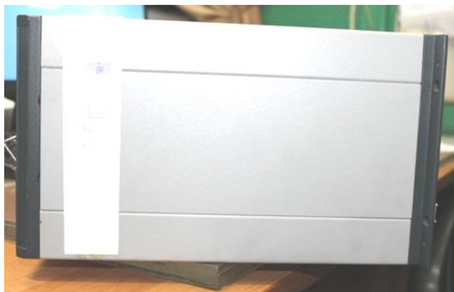
Рисунок 3 – Схема пломбировки от несанкционированного доступа МІС-036R
