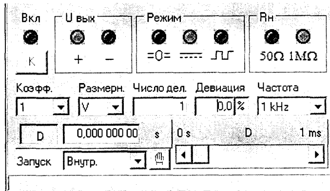
Рисунок 1 – Начальные положения органов управления на панели управления «УИ К2С-62А КУ» установки при опробовании в режиме работы «КУ»
