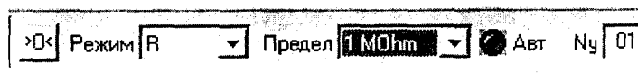
Рисунок 4 – Начальные положения органов управления на панели управления «УИ К2С-62А ММ» установки при опробовании в режиме «ММ» при измерении электрического сопротивления
