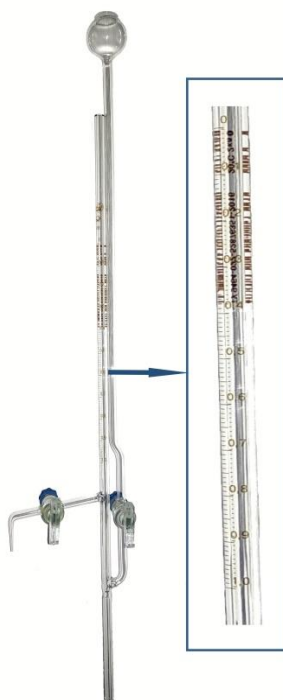
Рисунок 1 – Общий вид бюреток лабораторных стеклянных «МиниМедПром», тип 1, исполнение 2
