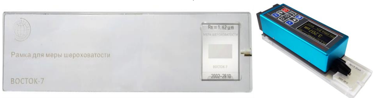
Рисунок 1 – Общий вид меры шероховатости поверхности в пластиковом прозрачном основании(а) и размещение меры в установочную рамку с выемкой и установка прибора для измерения шероховатости на рамке (б)
