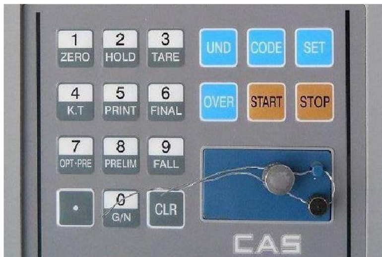
Рисунок 2 – Способ пломбировки от несанкционированного доступа.
