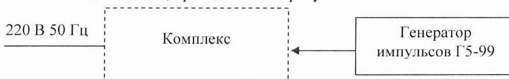
Рисунок 8 – Схема подключения приборов для измерений импульсных сигналов
