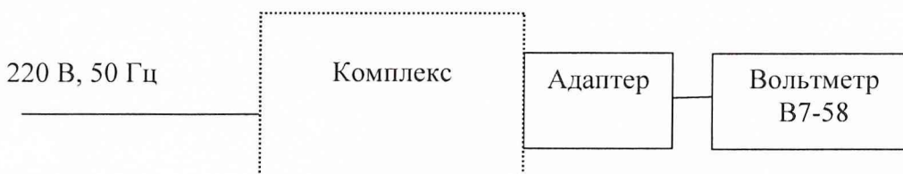
Рисунок 2 – Схема подключения для измерения напряжения питания 12 и 27 В
