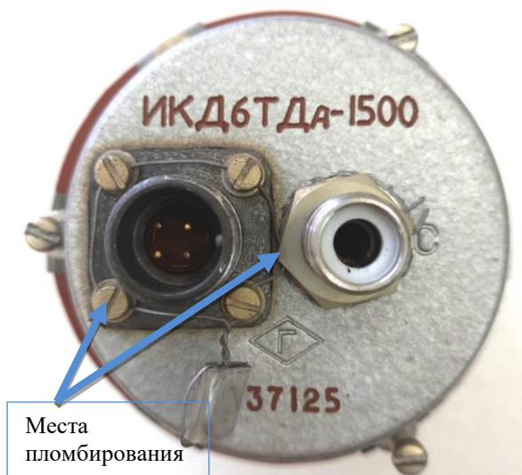
Рисунок 2 – Места пломбировки от несанкционированного доступа
