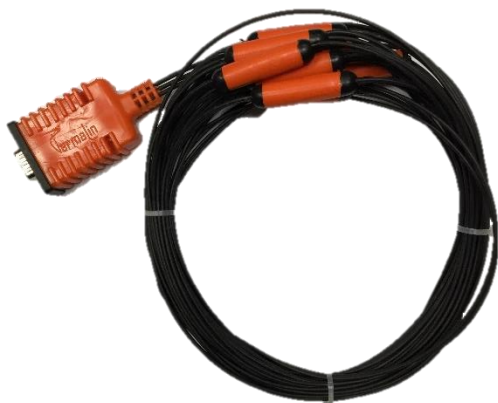
Рисунок 1 – Общий вид термокосы «Termalin ТК»
