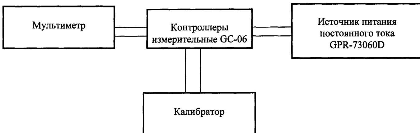
Рисунок 1 - Структурная схема определения погрешности измерений (преобразований)
