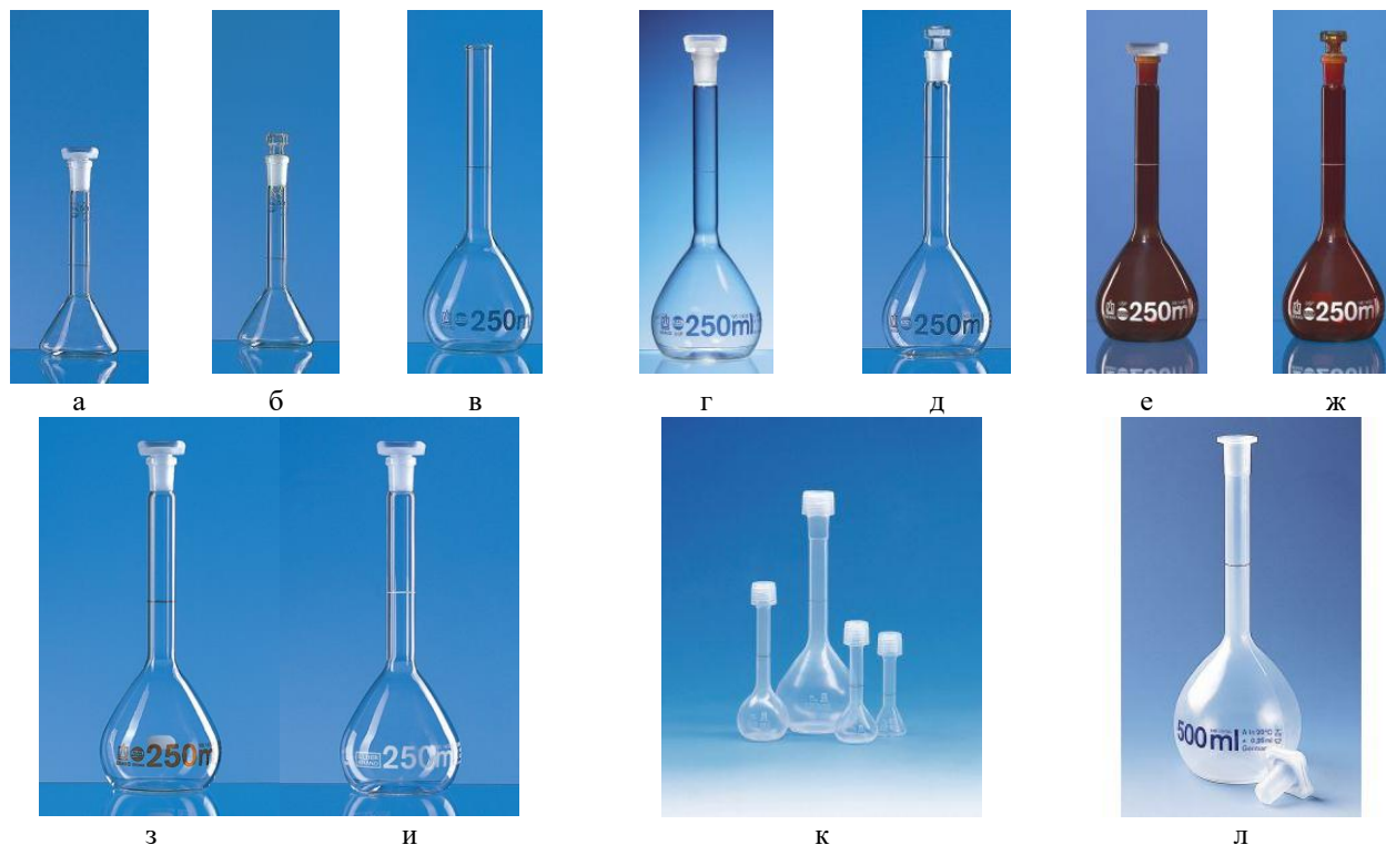
Рисунок 1 – Общий вид колб: а, б – серия BLAUBRAND конической формы с пробкой из ПП, со стеклянной пробкой; в – серия BLAUBRAND с рантом; г – серии BLAUBRAND, BLAUBRAND USP, BLAUBRAND PUR protect с пробкой из ПП; д – серии BLAUBRAND, BLAUBRAND USP со стеклянной пробкой; е, ж – серии BLAUBRAND, BLAUBRAND USP из темного стекла с пробкой из ПП, со стеклянной пробкой ; з – серия BLAUBRAND ETERNA с пробкой из ПП ; и – серия SILBERBRAND с пробкой из ПП; к – пластиковая с закручивающейся крышкой; л – пластиковая с пластиковой пробкой
