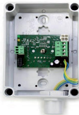
Рисунок 2 – Общий вид датчиков токсичных газов PolyGard 2 MC2 с открытой крышкой корпуса
