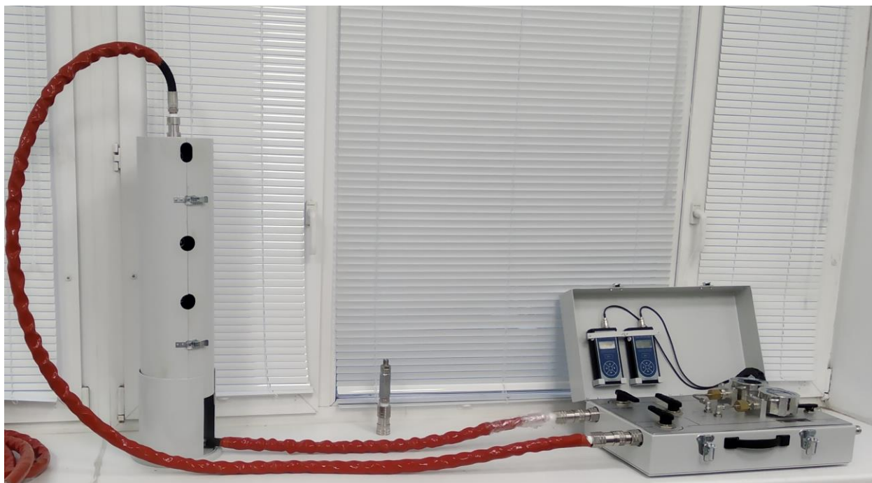
Рисунок 1 – Общий вид гидравлического блока установки ПУ-01 с подключенным блоком напорных пикнометров (на рисунке слева)
