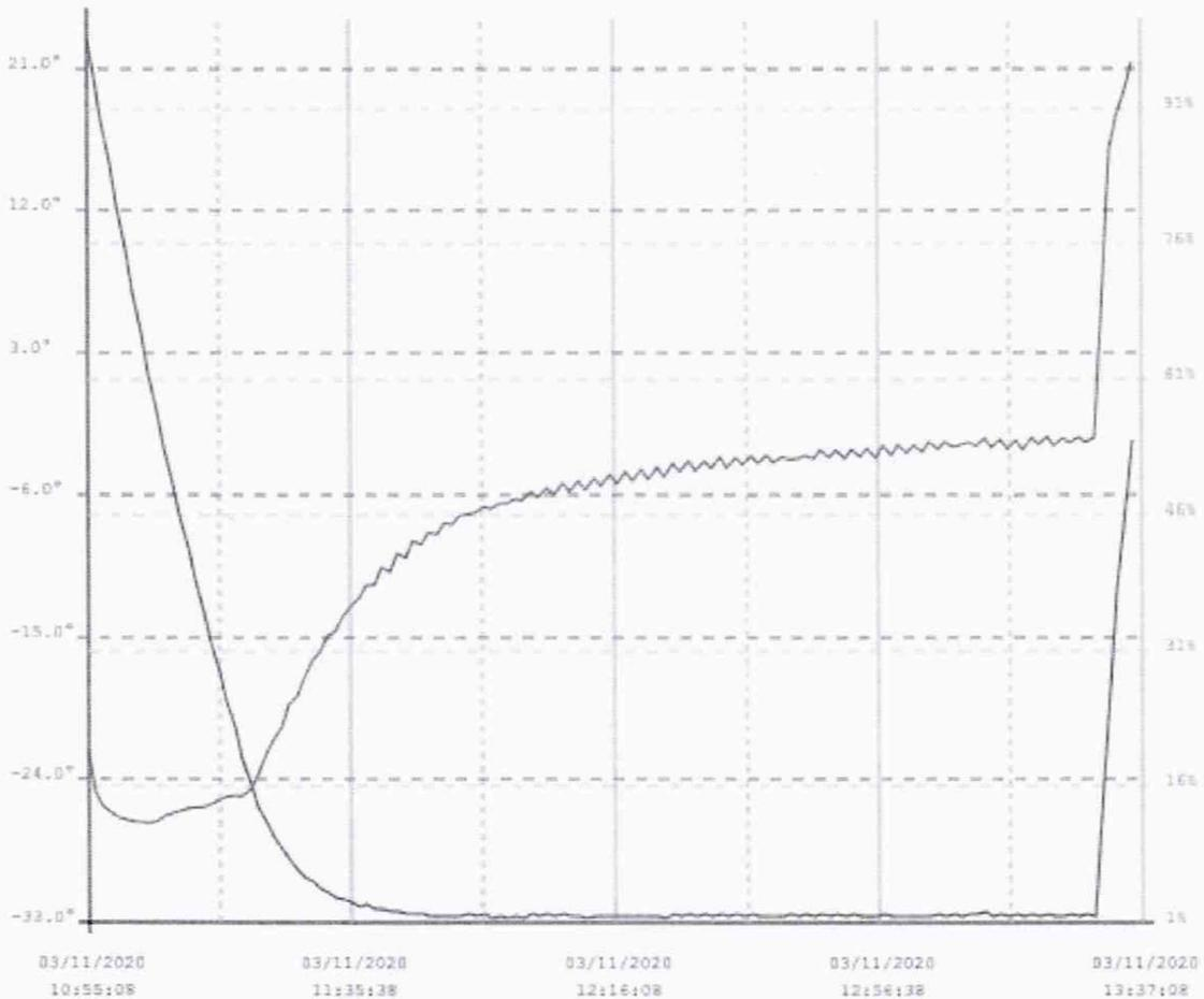
6. Программа *iPlug Manager* также позволяет получить информацию об измеренных данных. Для этого необходимо подключить терморегистратор к компьютеру (в соответствии с п. 2) и после появления на экране окна с настройками зайти в раздел «Read Temperatures» («Считывание данных температуры»). В данном разделе можно дополнительно сформировать отчет об измерениях в формате «csv» («Download CSV»).
