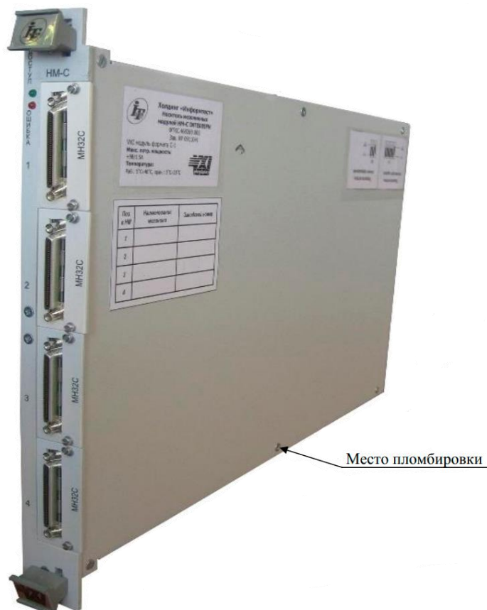
Рисунок 3 – Общий вид мезонинных модулей типа HM-C (HM, HM-M, HМУ, HMHC) с установленными МН32С и схемой пломбировки от несанкционированного доступа
