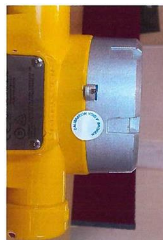
Рисунок 4 – Газоанализаторы серии Sensepoint модификации Sensepoint XCD (XCD, XCD RTD, XCD RFD) с пломбой
