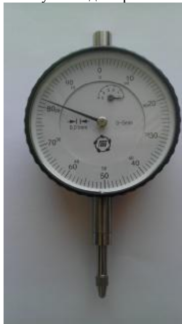
Рисунок 1 – Общий вид индикаторов часового типа с ценой деления 0,01 мм.
