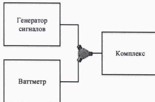
Рисунок 1 - Схема подключения для определения погрешности измерений уровня сигнала
