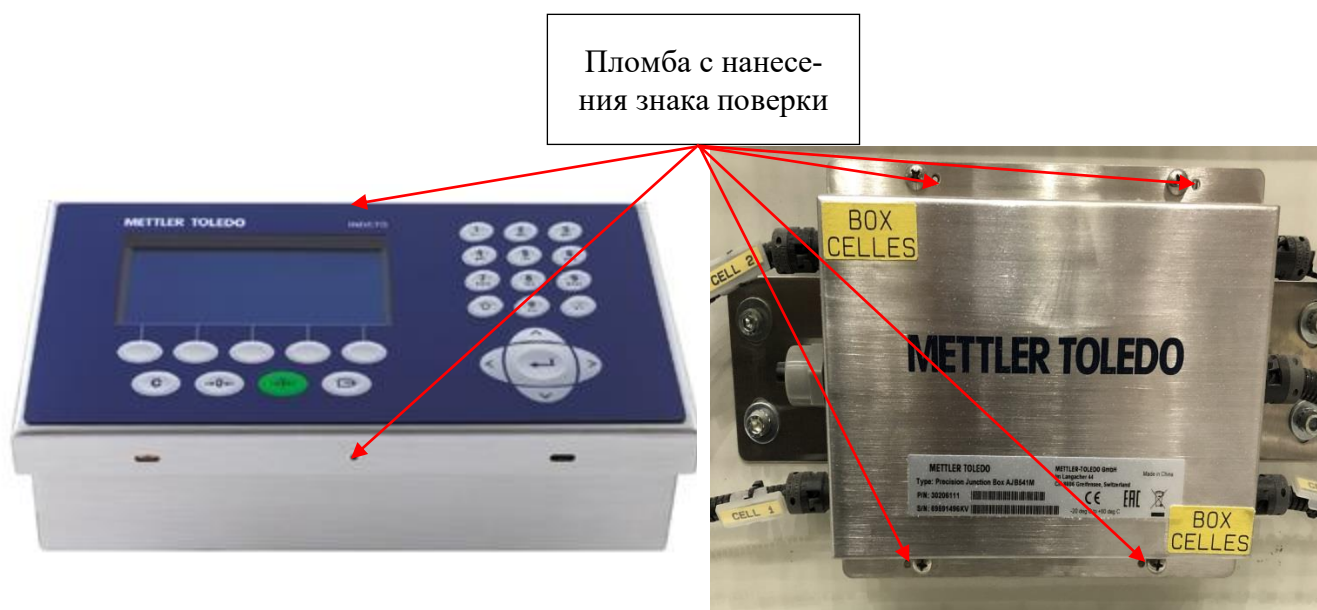
Рисунок 3 - Схема пломбирования весов от несанкционированного доступа к местам настройки (регулировки)
