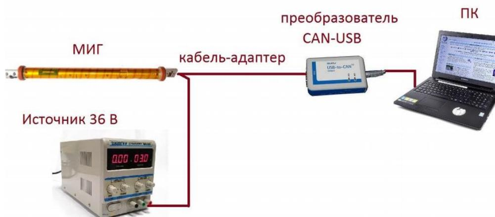
Рисунок 2 – Блок-схема соединения забойной и наземной частей модулей инклинометрии МИГ
