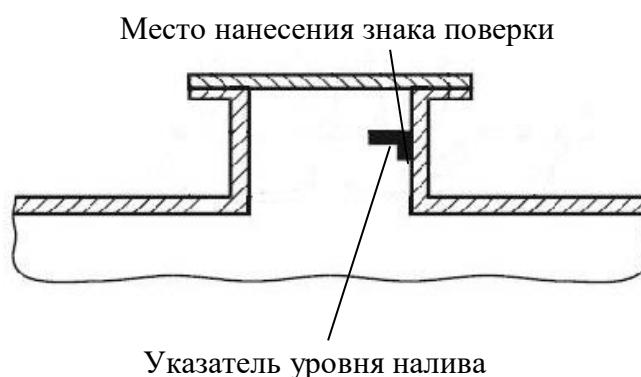
Рисунок 3 – Схема пломбировки от несанкционированного изменения положения уровня налива, обозначение места нанесения знака поверки
