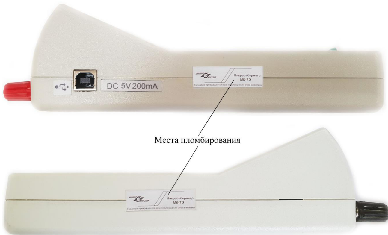
Рисунок 2 – Схема пломбировки от несанкционированного доступа
