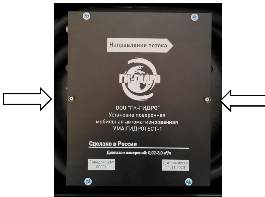
Рисунок 2 – Схема пломбировки от несанкционированного доступа, обозначение места нанесения знака поверки Место нанесения знака утверждения типа и заводского номера представлены на рисунке 3.
