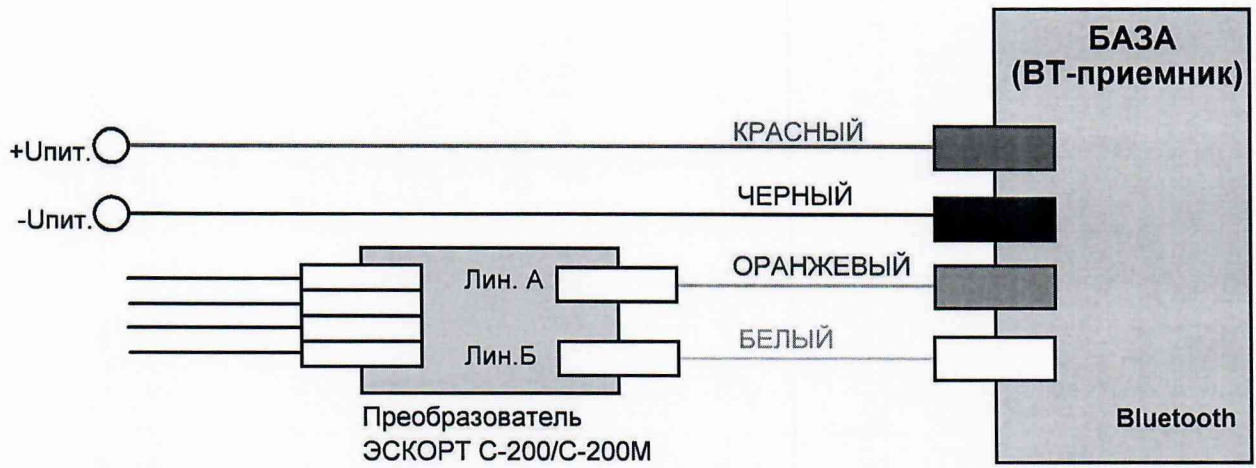
Рисунок А.1 – Схема подключения к ПК
