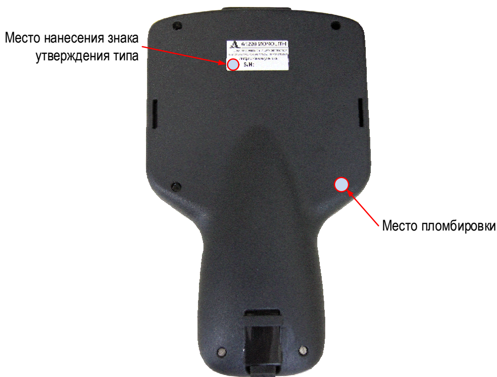
Рисунок 2 – Место пломбировки корпуса дефектоскопа и место знака утверждения типа
