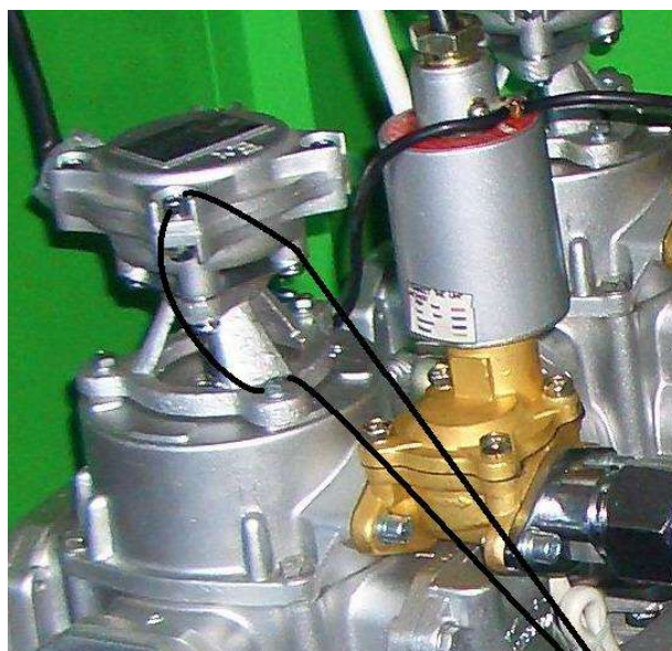
Схема 1. Схема пломбировки установленного блока управления (через отверстие в крепежном болту)
