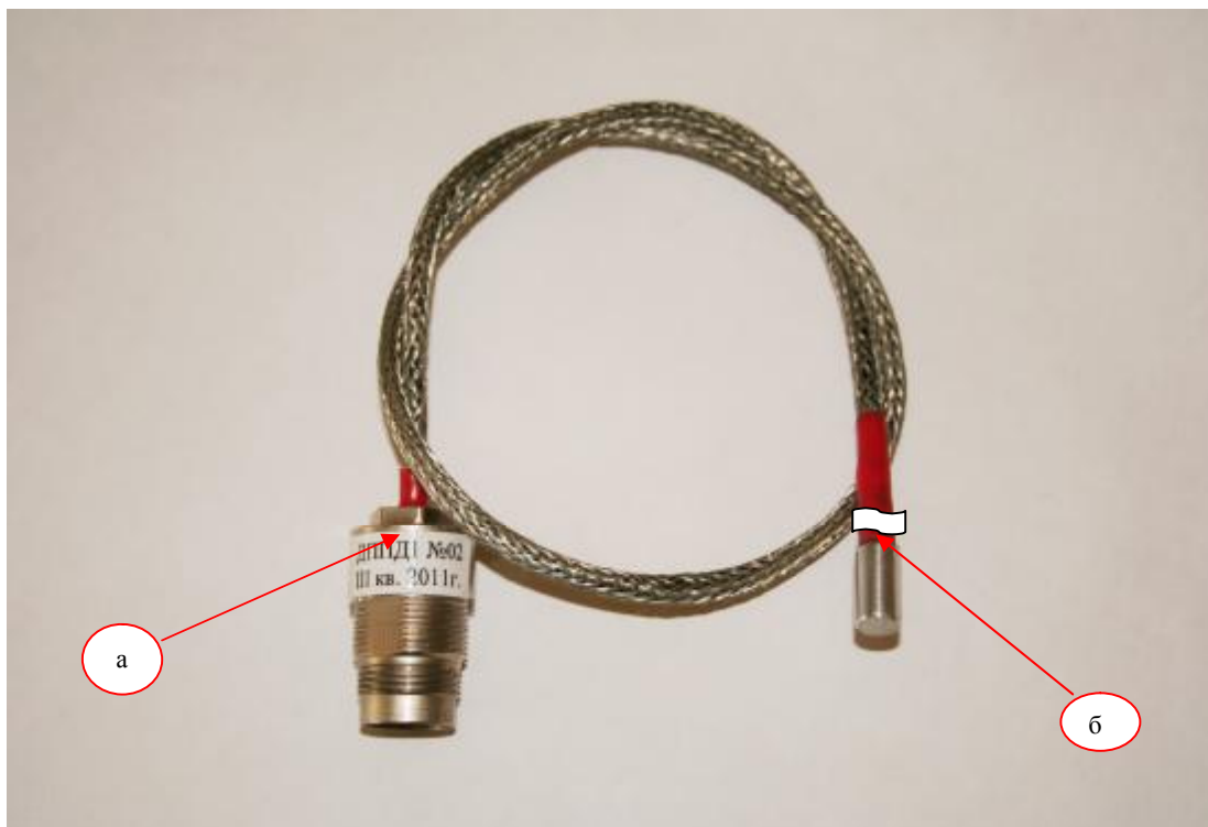
Рисунок 2 – Место нанесения наклейки (а) и пломбировки (б) детектора
