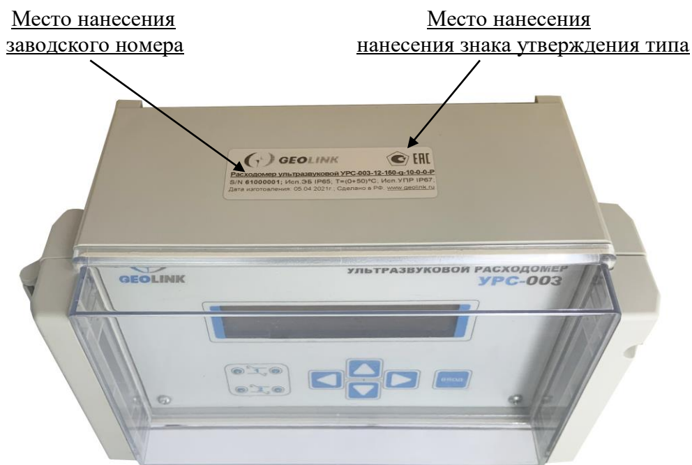
Рисунок 3 – Места нанесения заводского номера и знака утверждения типа
