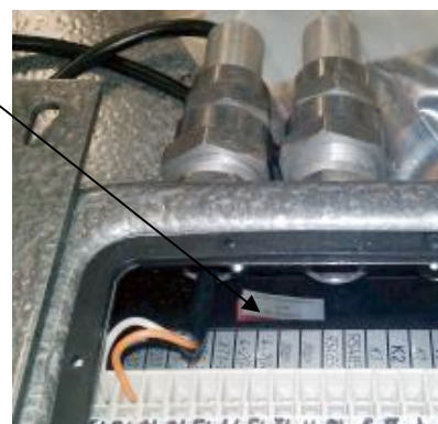
Рисунок 17 – Схема пломбировки вычислителя не взрывозащищенного исполнения Рисунок 18 – Схема пломбировки вычислителя взрывозащищенного исполнения
