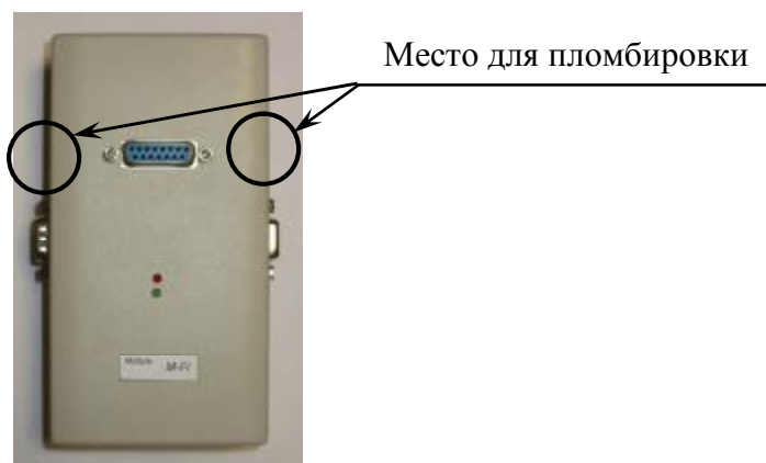
Рисунок 3 – Схема пломбировки измерительных модулей.
