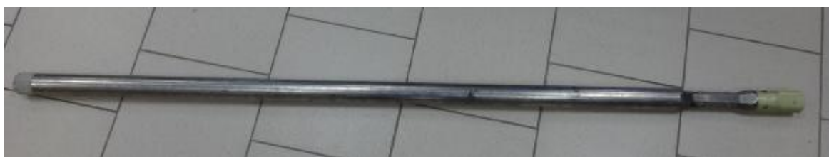
Общий вид модулей инклинометрии и гамма-каротажа МИГ
