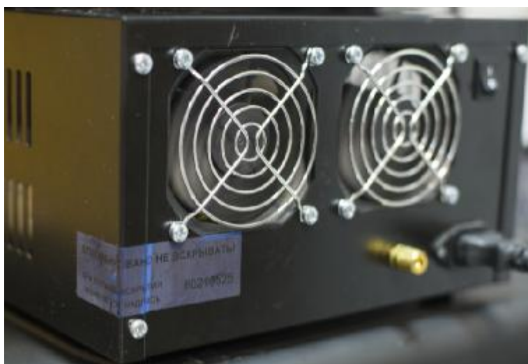
Рисунок 2 – Схема пломбировки оптоэлектронного блока от несанкционированного доступа
