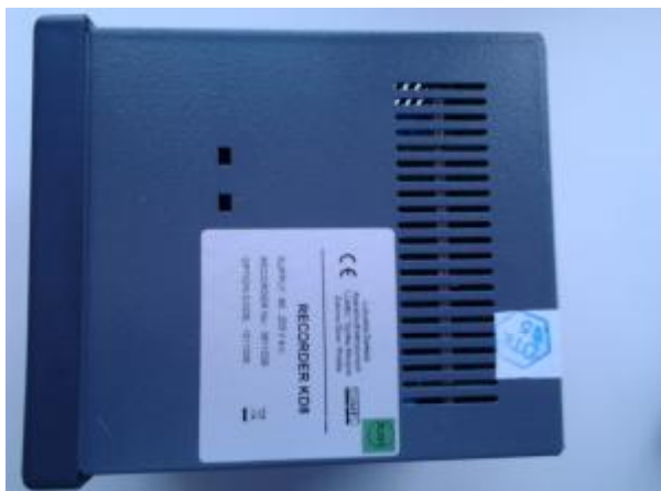
Рисунок 2 – Размещение информационной этикетки и пломбирующая наклейка с клеймом для первичной поверки (пример расположения)
