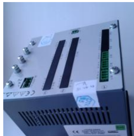
Рисунок 3 – Размещение пломбирующей шильды. Две необратимо разрушающихся при попытке вскрытия шильды исключают возможность демонтажа задней крышки корпуса для доступа к электронной плате прибора. Показано с примером расположения клейма первичной поверки
