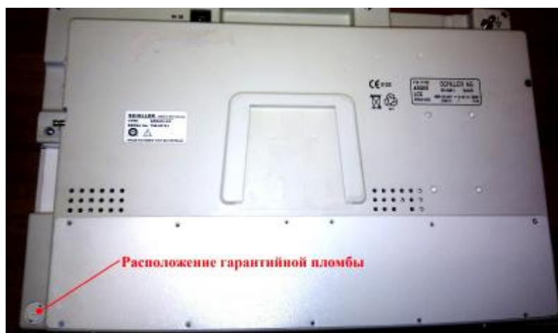
Рисунок 4 – Схема пломбировки монитора пациента ARGUS LCX
