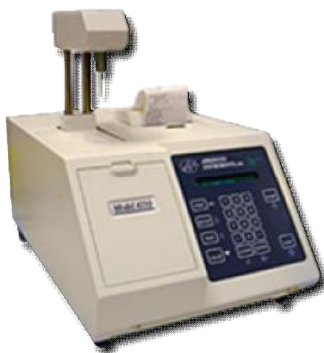
Рис.1 Криоскоп Advanced модель 4250
