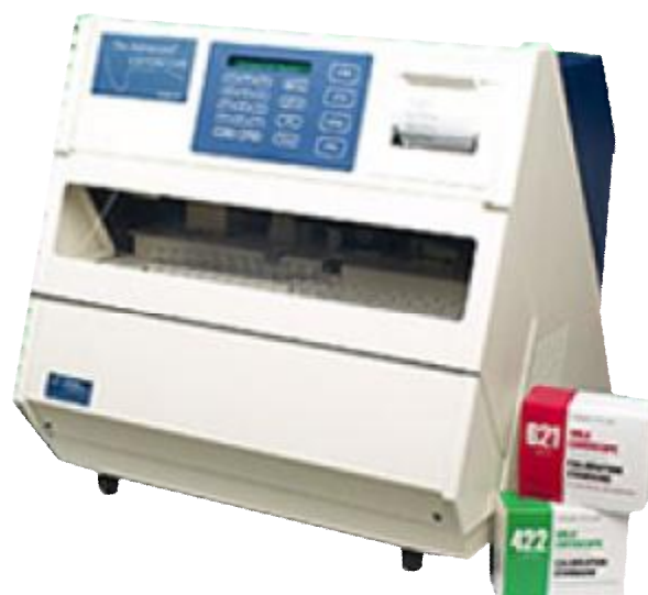
Рис.2. Криоскоп Advanced модель 4С3
