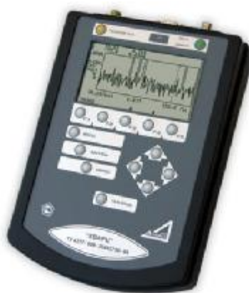
Рисунок 1 - Внешний вид коллектора данных /анализатора КУ80-В
