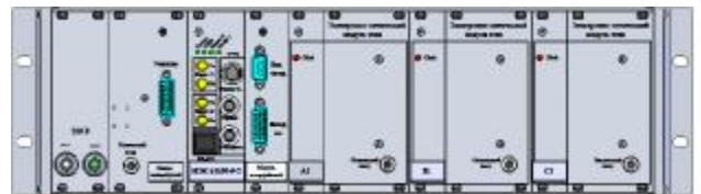
Рисунок 9 – электронный блок трансформаторов (вид сзади)
