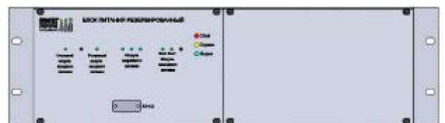
Рисунок 11 – электронный блок резервированного блока питания повышенной надежности (вид спереди)
