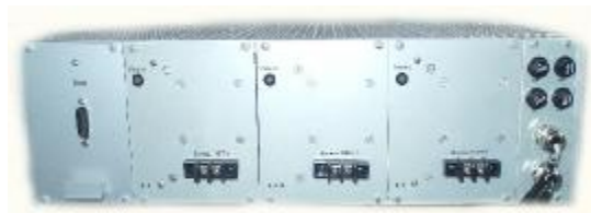
Рисунок 7 – Электронный блок ЦАП Н для вывода пропорционального аналогового сигнала 100/\sqrt{3} В трансформаторов вид сзади
