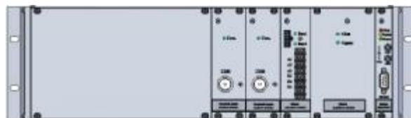
Рисунок 9 – Электронный блок резервированного блока питания повышенной надежности (вид сзади)
