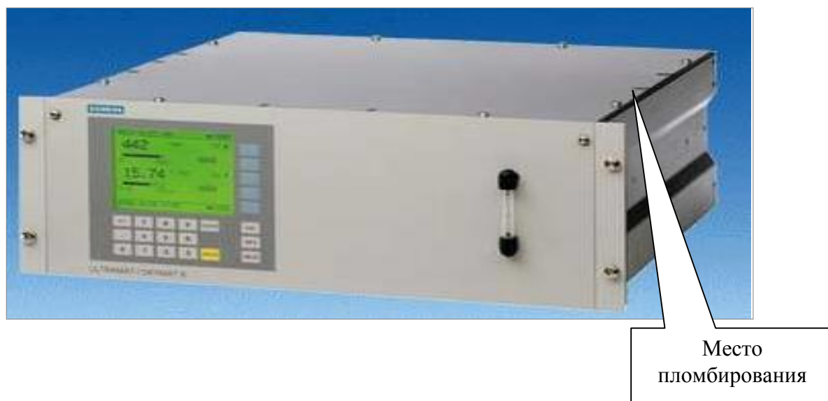
Рисунок 1 – Газоанализатор Ultramat 6E - C 3 H 8 - рабочий эталон 1-го разряда, внешний вид.
