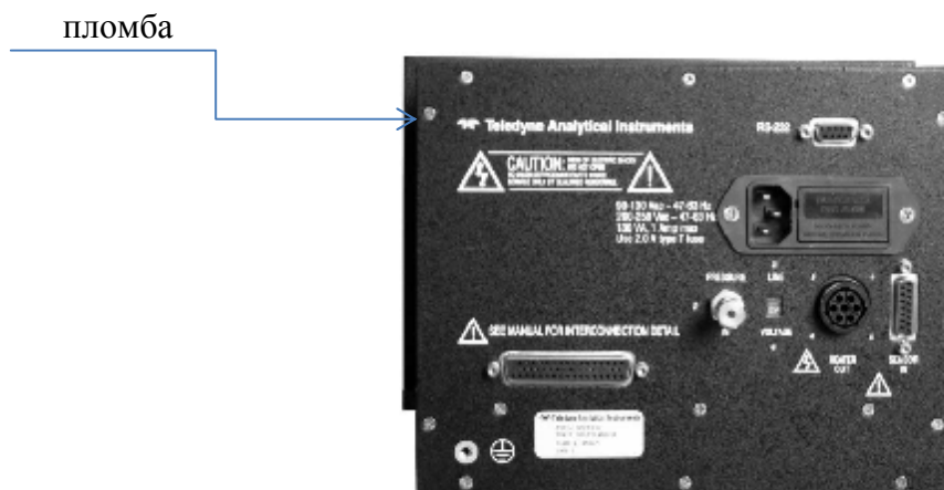
Рис. 2. Внешний вид задней панели блока управления газоанализатора Teledyne 3010 MA – O 2 – рабочего эталона 1-го разряда.
