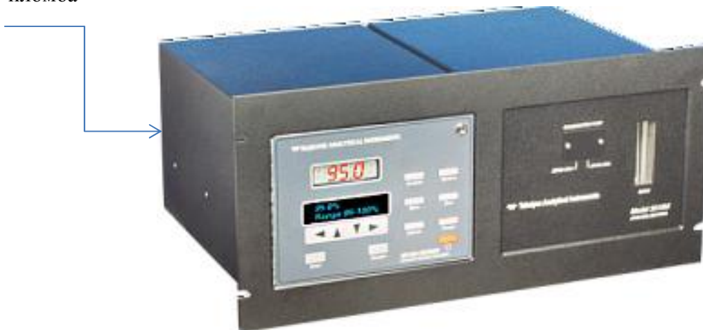
Рис. 1. Газоанализатор Teledyne 3010 MA – O 2 – рабочий эталон 1-го разряда.
