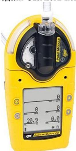
Рис. 11. Общий вид газоанализаторов BW модели GasAlertMicro5 PID с насосом
