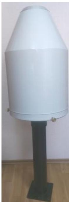
Рисунок 2 – Внешний вид осадкомеров
