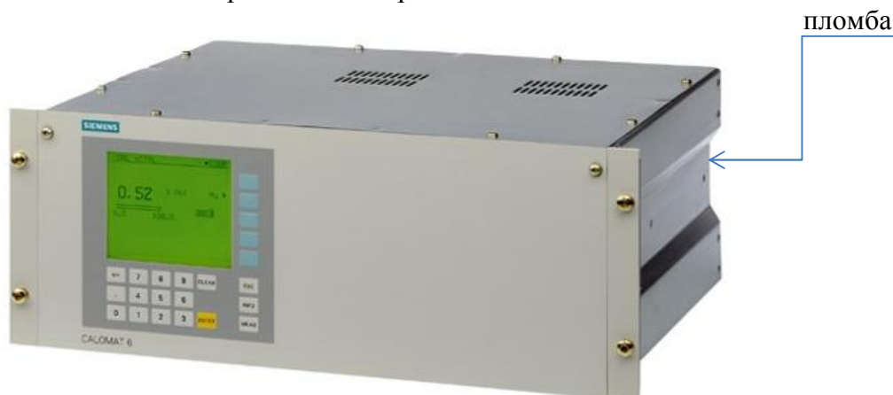
Рис. 1. Газоанализатор Calomat 6 – H 2 – рабочий эталон 1-го разряда.
