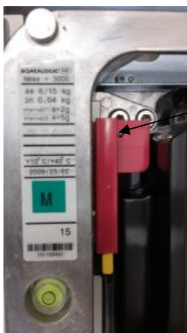
Рисунок 1 - Схема пломбирования от несанкционированного доступа в трех точках
