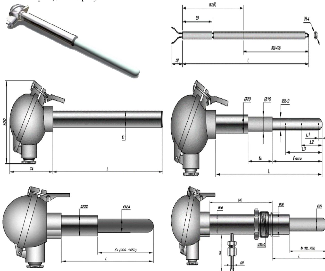
Рисунок 1 – Датчики температуры ТПШТ, ТПРТ, ТПВР, ТПШТ Ex, ТПРТ Ex
